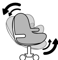
MECANISMO ASSÍNCRONIZADO: O encosto e o assento adaptam-se de forma independente aos movimentos da pessoa sentada. Permite uma melhor adaptação ao corpo.
