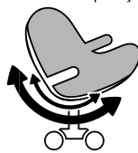
BASCULANTE CENTRADO: O assento e o encosto movem-se sempre à vez, mantendo ambos sempre no mesmo ângulo.
